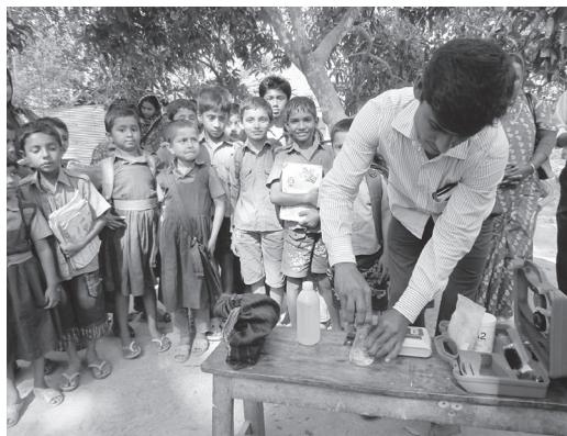
写真3 現場で簡単にヒ素濃度を測定できる「フィールドキット」
