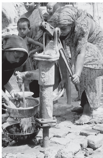
写真1 ガンジス川流域で、地下水の汲みあげに使うチューブウェル（管井戸）
